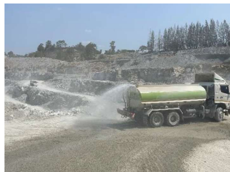
รูปที่ 2-8: การฉีดพรมน้ำบริเวณหน้าเหมือง
